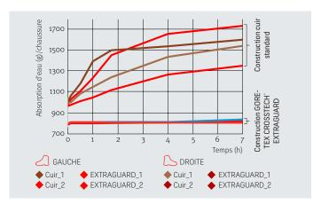
Par rapport aux chaussures d'intervention feu traditionnelles, les chaussures GORE-TEX CROSSTECH® EXTRAGUARD se distinguent par leur faible absorption d'eau, ce que confirme l'essai en seau d'eau.
