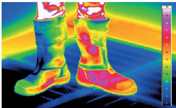
Der Wärmeverlust bei einem GORE-TEX CROSSTECH® EXTRAGUARD Stiefel ist erheblich geringer als bei einem baugleichen Lederstiefel.
